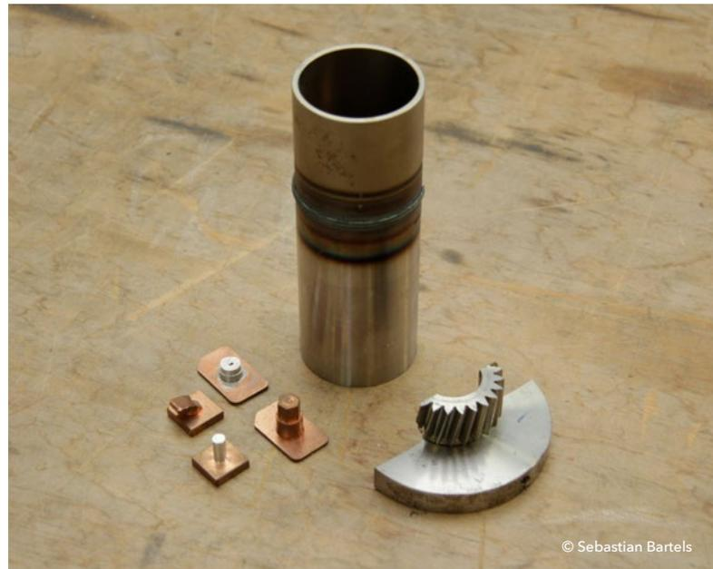
Verschiedene metallische Bauteile, die durch Reibschweißen hergestellt wurden
